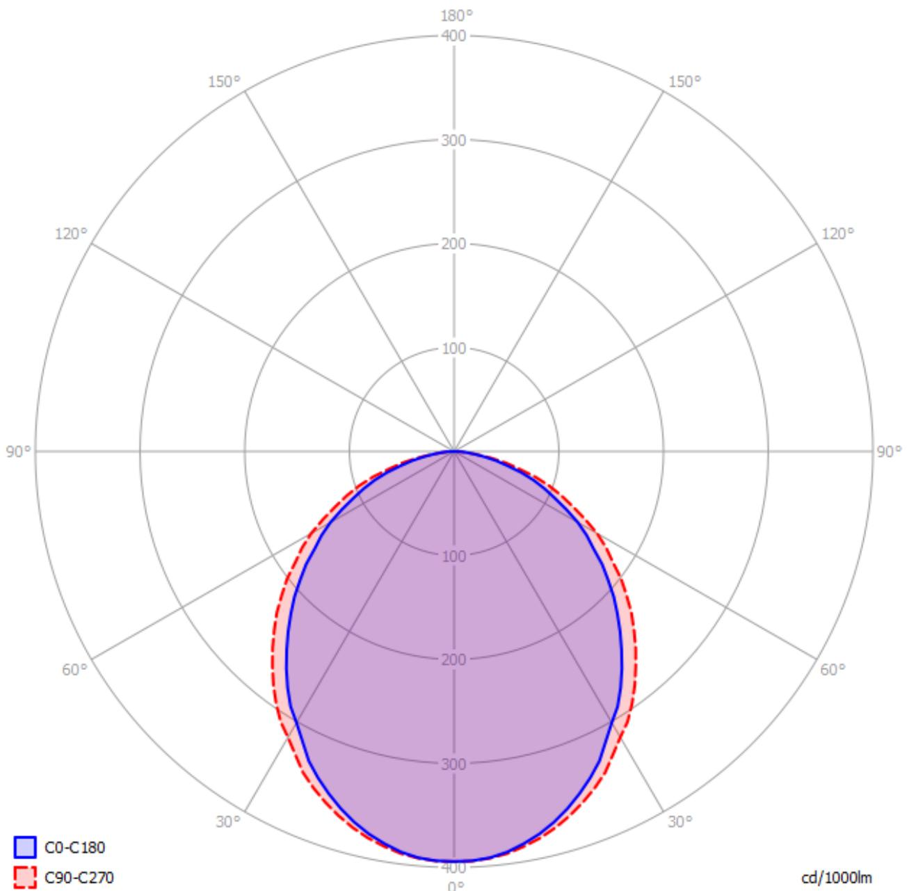
Das Lichtdiagramm für die beiden C Flächen.
