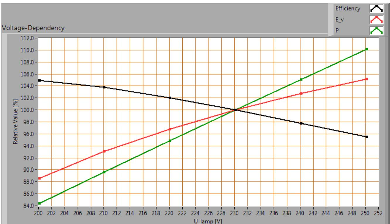
Abhängigkeit von Lampenparametern von der eingestellten Lampenspannung.
