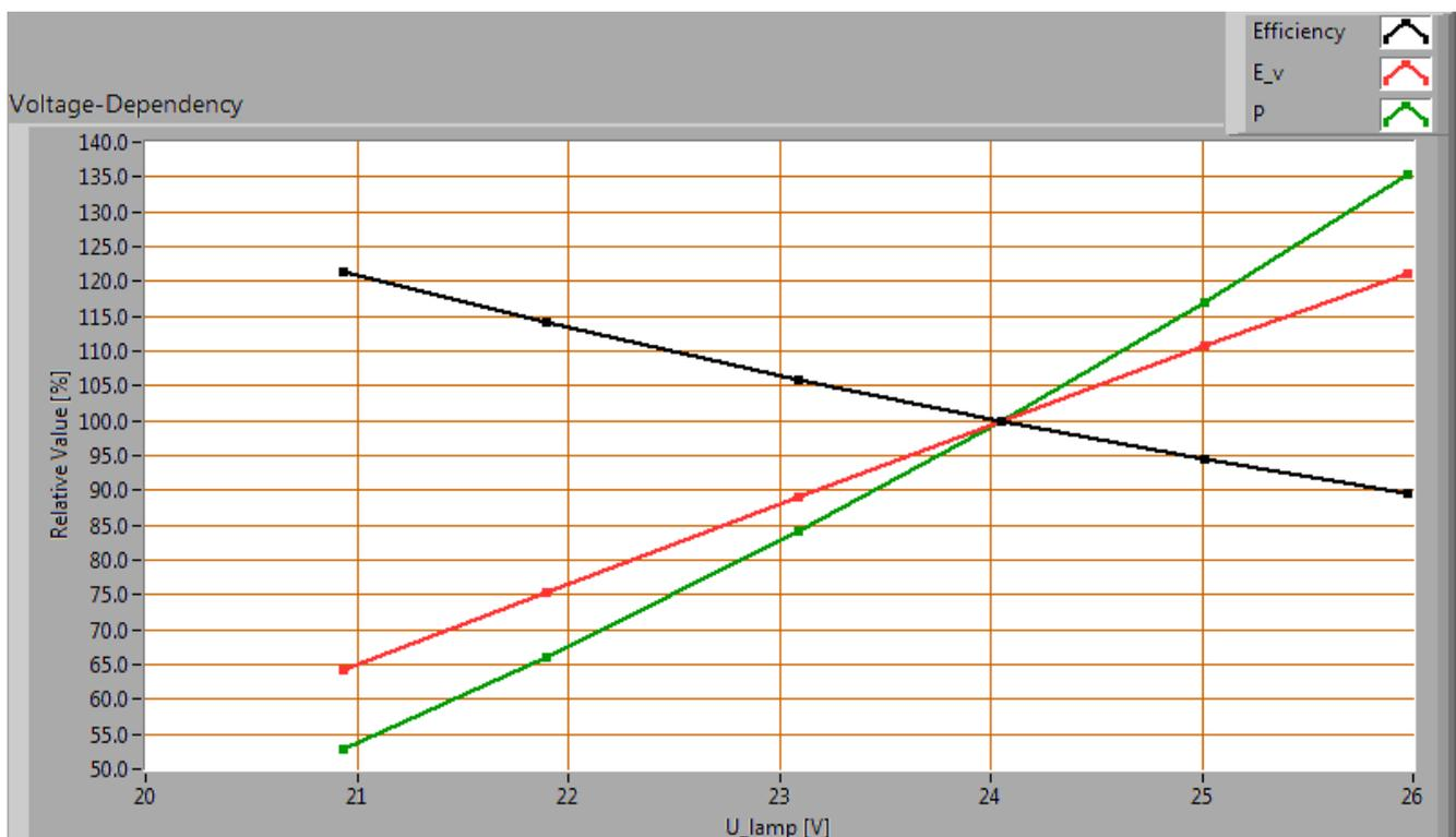
Abhängigkeit von Lampenparametern von der eingestellten Lampenspannung.
