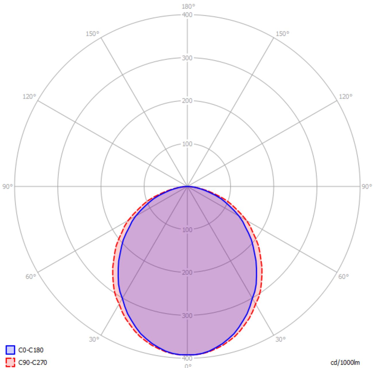
Das Lichtdiagramm für die beiden C Flächen.
