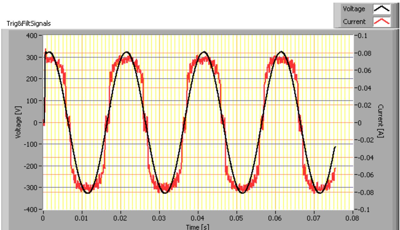
Maximaler Einhaltstrom gemessen mit schlimmsten Startphasenwinkel der Spannung
