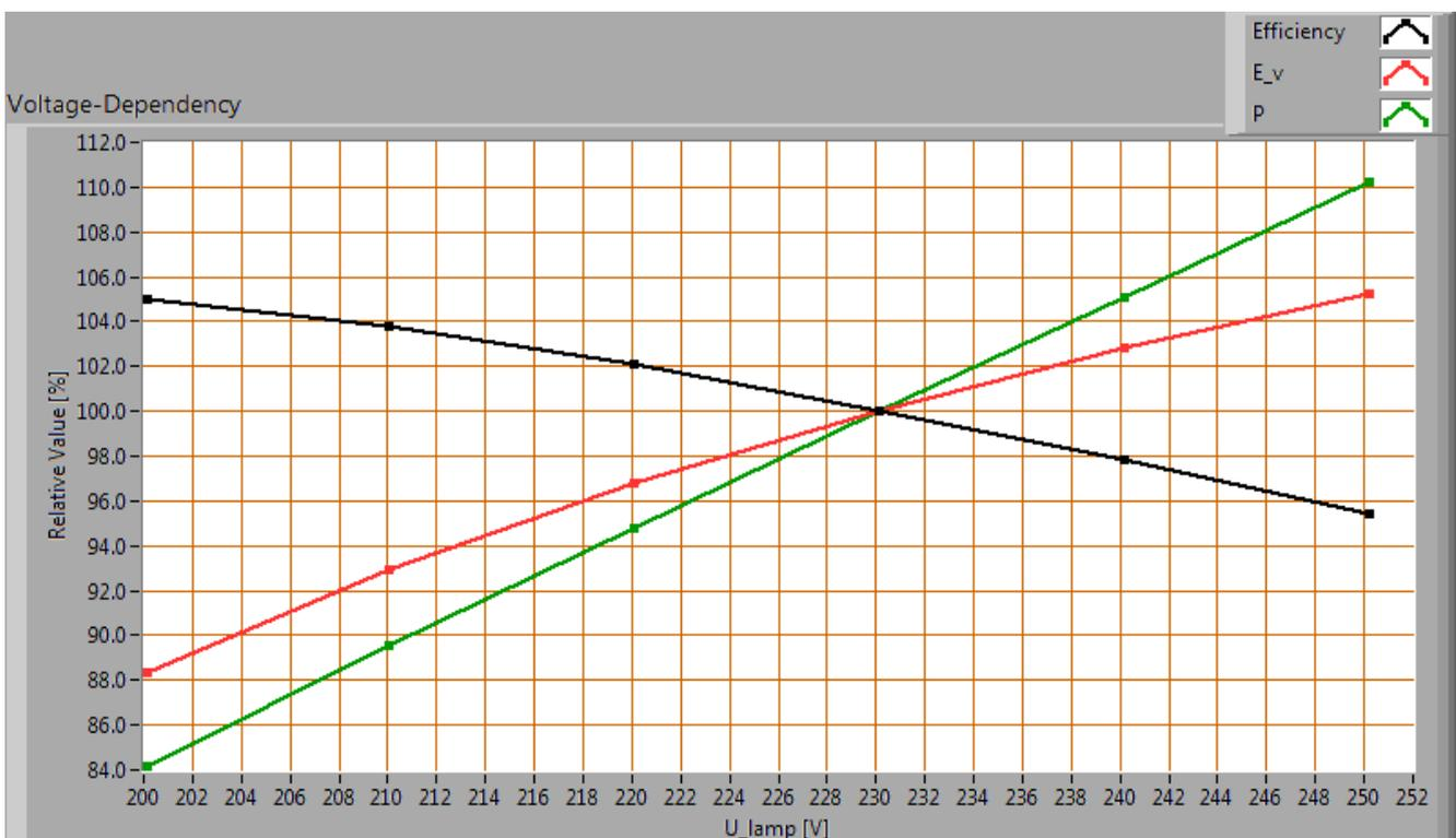
Abhängigkeit von Lampenparametern von der eingestellten Lampenspannung.
