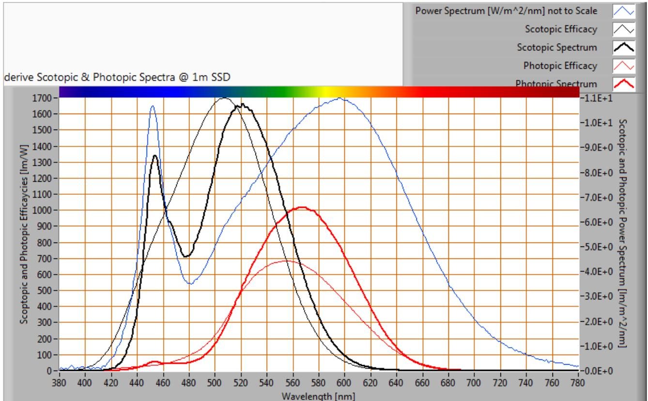
*La puissance spectrale, les courbes de sensibilité, et les spectres de jour et de nuit en résultant (ces derniers obtenus à 1 m de distance).*
