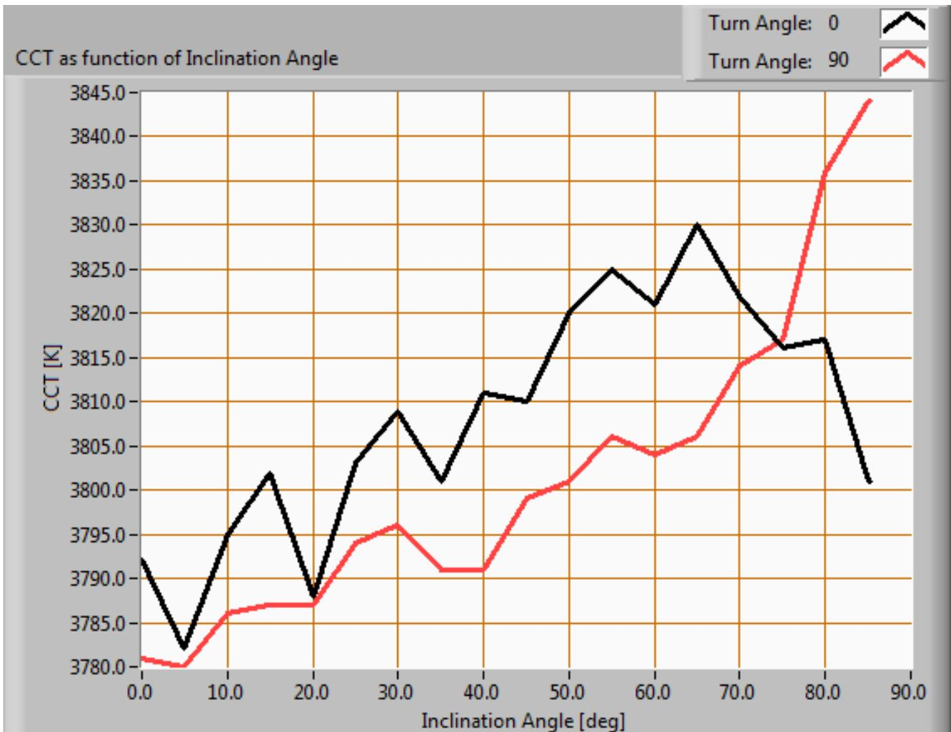
*La température de couleur de la lampe est dépendante de l'angle d'inclinaison.*
