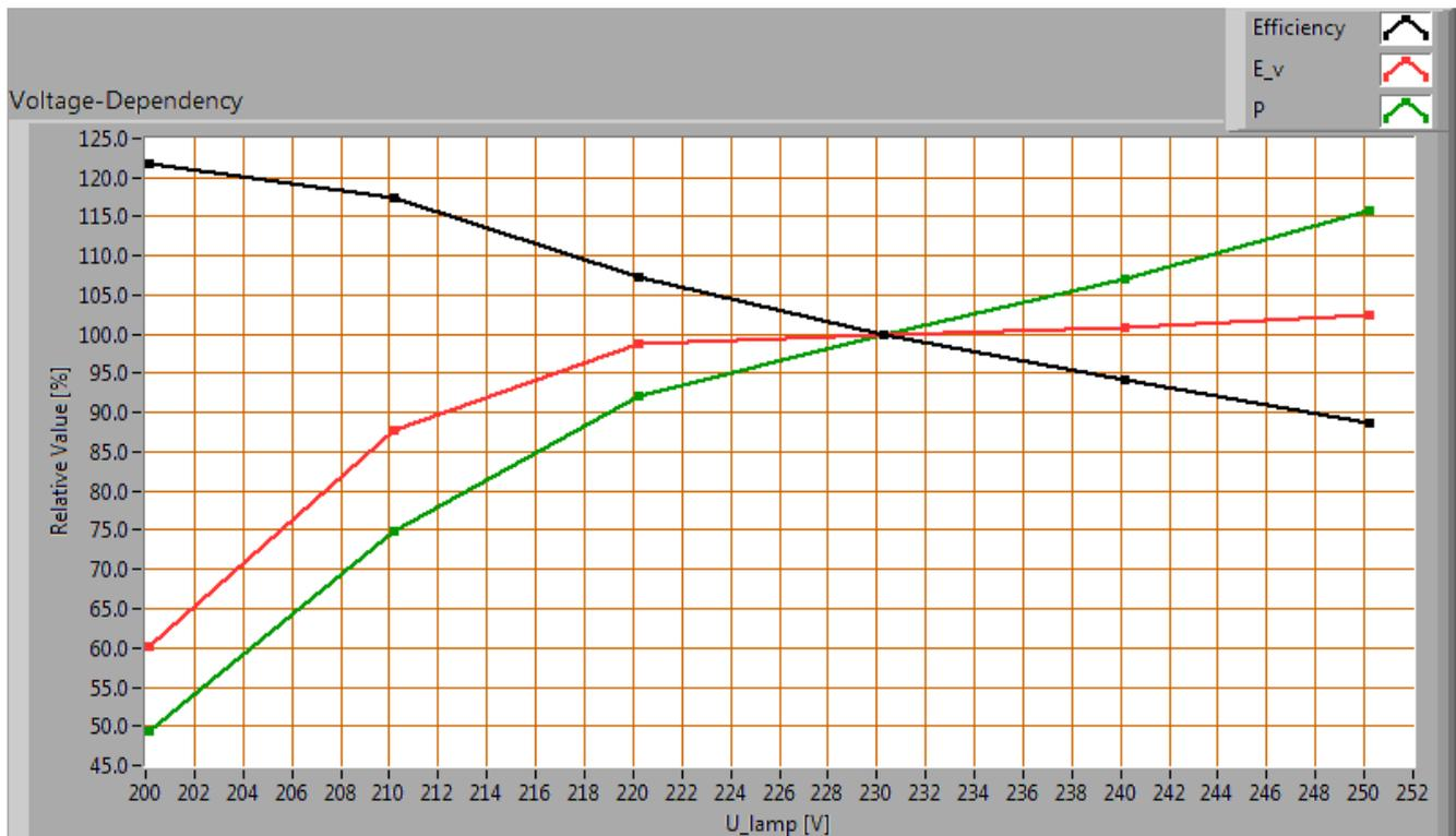
*Abhängigkeit von Lampenparametern von der eingestellten Lampenspannung.*
