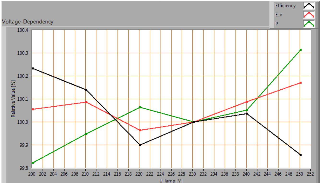
*Abhängigkeit von Lampenparametern von der eingestellten Lampenspannung.*
