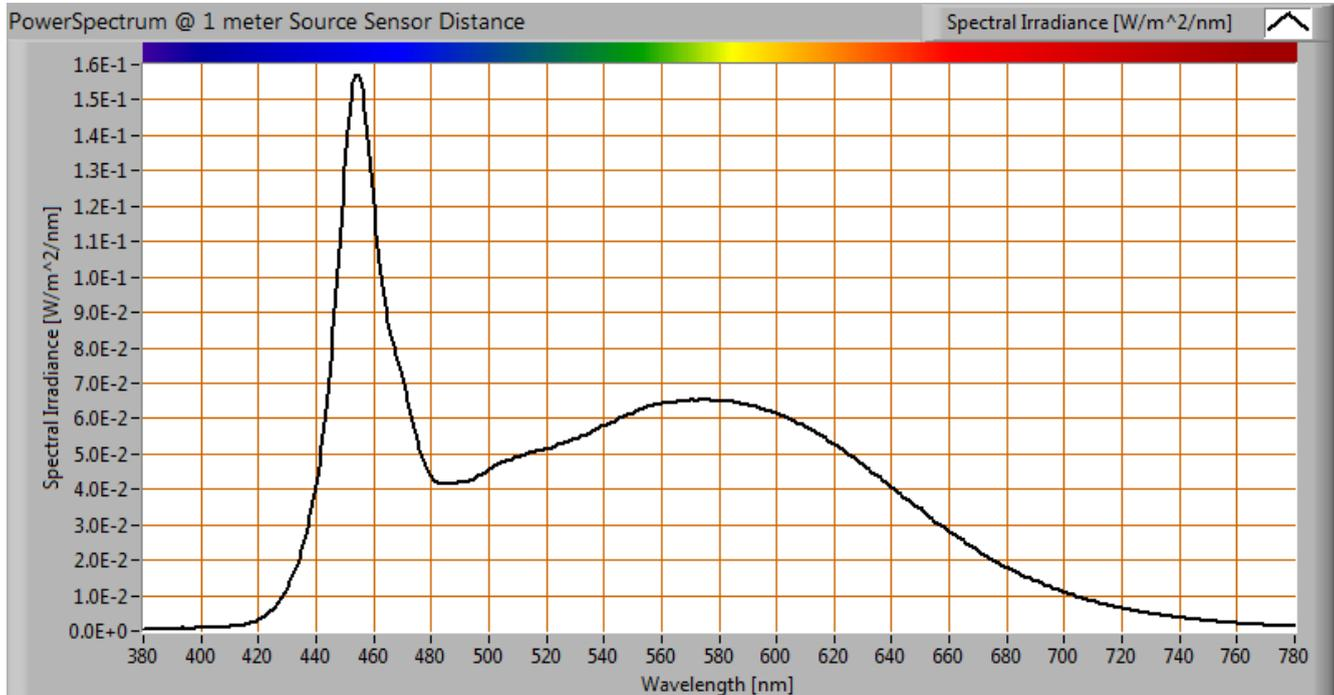
Das Farbspektrum des Lichtes dieser Lampe. Energieniveaus bei 1 Meter Abstand.
