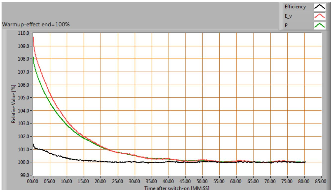
Echauffement de la lampe et les effets sur les paramètres de la lampe; 100 % du niveau déterminé au début et à la fin.
