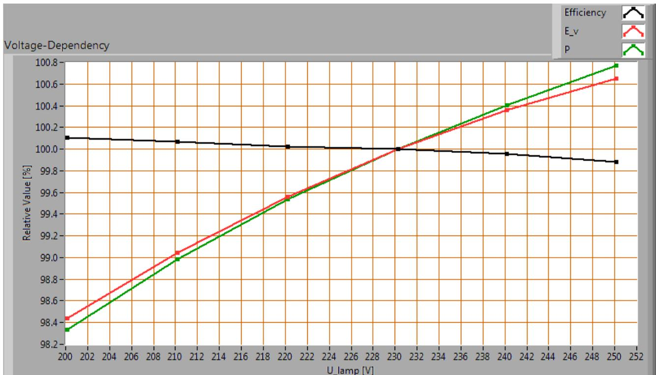
*Dépendance des paramètres de la lampe à la tension ajustée de la lampe.*
