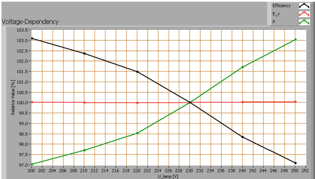
*Abhängigkeit von Lampenparametern von der eingestellten Lampenspannung.*
