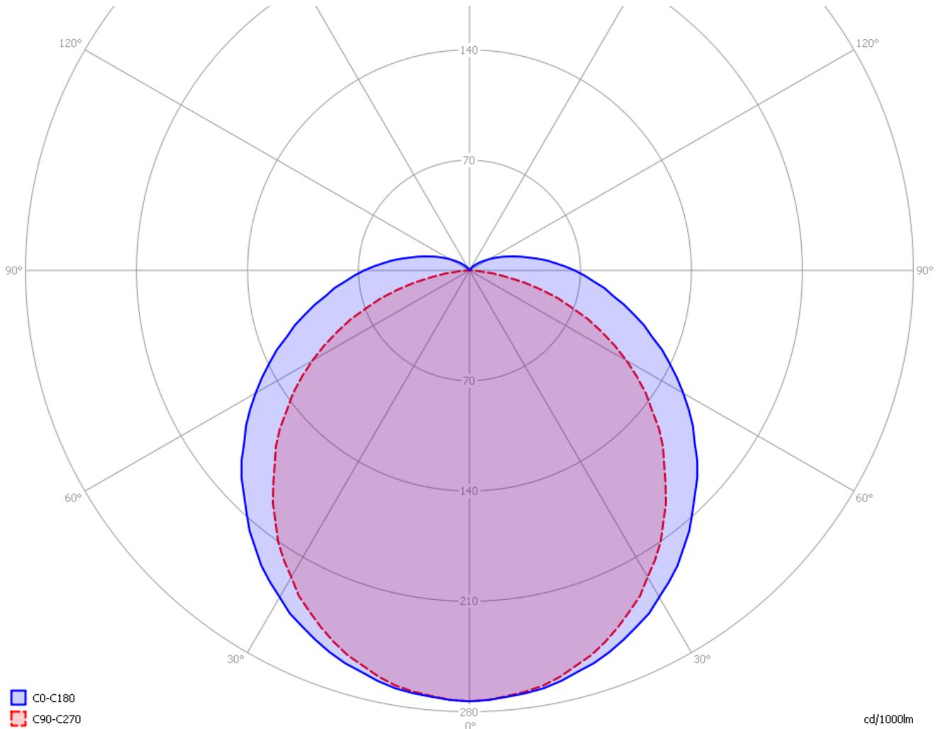
*Das Lichtdiagramm für die beiden C Flächen.*
