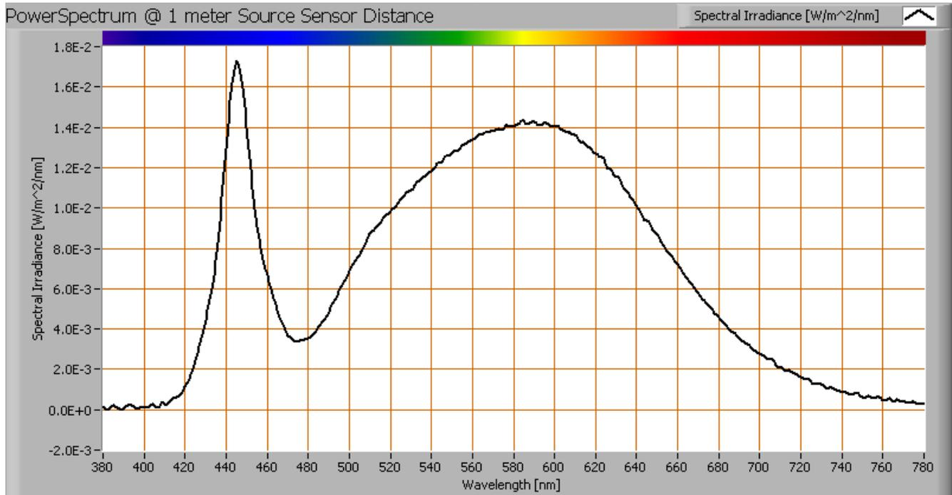
*Spectre visible de la lumière de cette lampe. Les niveaux énergétiques sont valables à un 1 m de distance.*
