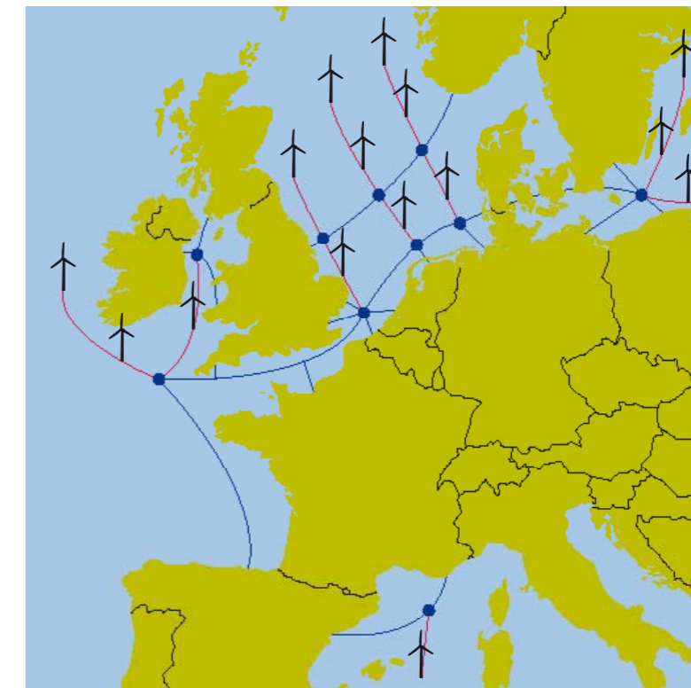
Een supergrid van hoogspanningskabels verbindt energieparken en diverse Europese landen met elkaar.
